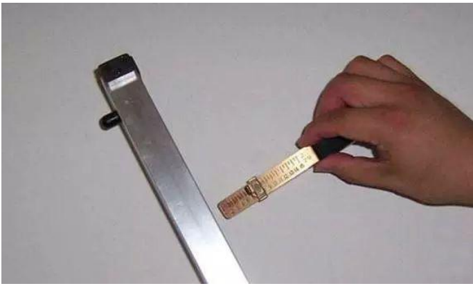
用两米靠尺和塞尺来测量墙面平整度
